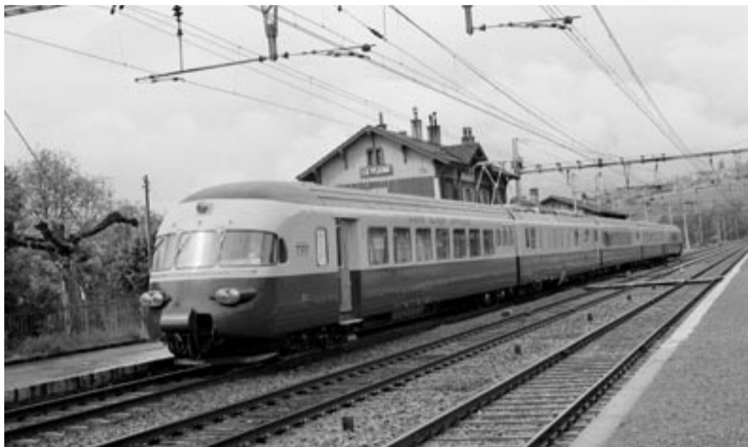
Der fabrikneue RAe TEE II 1053 bei einer seiner ersten Probefahrten unter Gleichstrom 1500 V auf der SBB-Strecke zwischen Genf und La Plaine, dem westlichsten Bahnhof der Schweiz, wo am 24. April 1961 das Bild entstand. Noch fehlt zwischen den Stirnfrontlampen das TEE-Logo. Foto: SBB Historic
